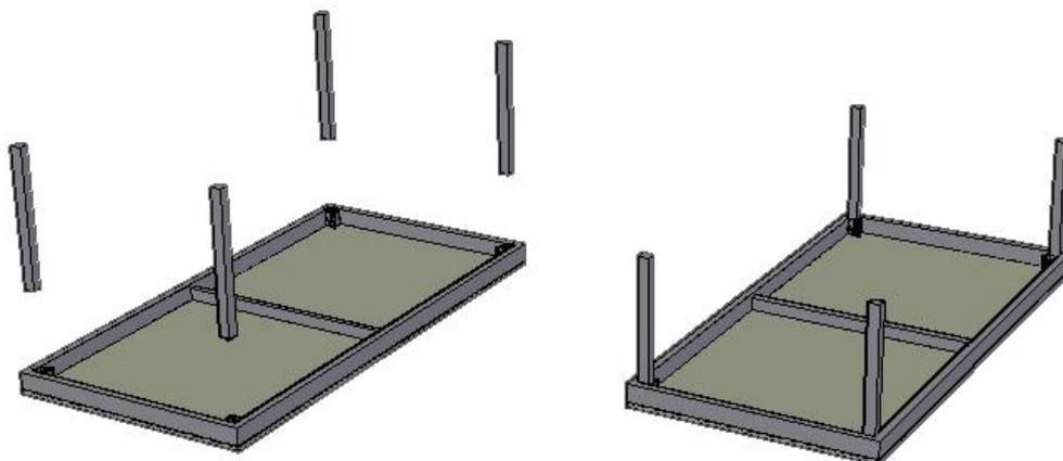
Armado de cada módulo con sus 4 patas
